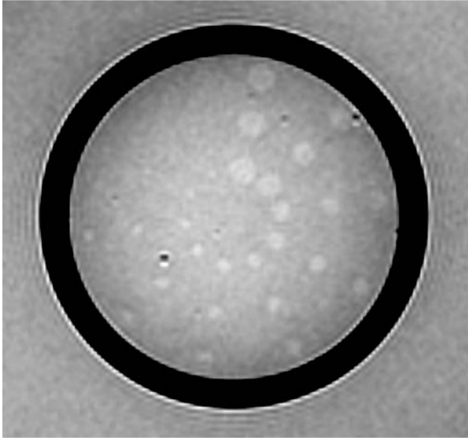
図 19： 低コントラスト物体のサークルを示した、スライス 8 の拡大トリミング画像。この画像では完全スポークが 9 と採点される。印刷画像では 9 番目のスポークが見えにくい。
